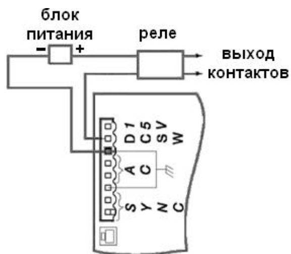
Реле подключено к контроллеру через внешний блок питания
