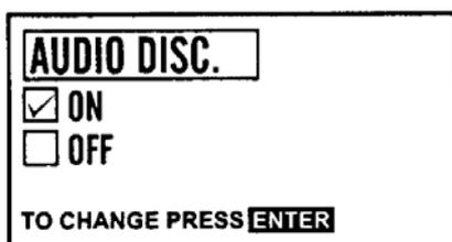
**4. Звуковая дискриминация.** Это способность металлоискателя отвергать мусор, производя различные звуки для различных типов объектов. Мусор отвергается в результате или отсутствия звукового сигнала или короткого дребезжащего звука. Ценные находки всегда дают четкий ровный сигнал.
