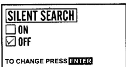
**5. Тихий поиск.** Это способность металлоискателя работать без порогового фона, который обычно слышен непрерывно в процессе поиска. Прибор молчит, пока объект не будет обнаружен.
