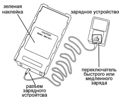
В комплект металлоискателя входят перезаряжаемая батарея. Ее можно заряжать сотни раз, если батарея правильно эксплуатируется, т.е. не хранится длительное время в заряженном состоянии или не перегружается при зарядке. Полная зарядка батареи может быть проведена при любом уровне ее разряда. При использовании режима быстрой зарядки следует руководствоваться нижеприведенным графиком для определения времени зарядки батареи. При нормальном режиме зарядки требуется 10-15 час
