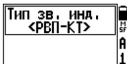
Данная опция позволяет менять тип звуковой индикации канала РВ (пороговый тон) между РВ, РВП и РВМ.
