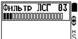
Опция позволяет выбрать уровень подавления ложных сигналов обусловленных повышенной электропроводностью грунта (засоленные почвы, морской пляж и т.д.).
