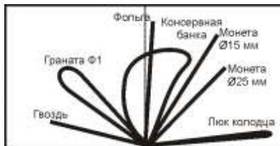
1. Годографы небольших и средних объектов из железа располагаются в левой половине экрана. Т.е. имеют наклон влево, относительно центра горизонтальной оси по нижней границе экрана.
