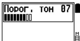
Данная опция позволяет проводить регулировку чувствительности (глубины обнаружения) порогового тона Вашего прибора. Пороговый тон - это сигнал канала обнаружения, дающий Вам информацию о том, что прибор обнаружил металлический предмет. С момента обнаружения и по ходу движения катушки громкость порогового тона возрастает, имея наивысшее значение над центром цели.
