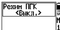
Данная опция позволяет включать и отключать недискриминационный алгоритм подавления сигнала от горячих камней. При его включении, на большую часть горячих камней округлой формы, сигнал идентификации
