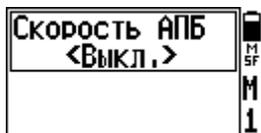
С помощью этой настройки Вы можете включать или отключать автоматическое слежение за изменением баланса грунта и его корректировку прибором в процессе работы (только для MSF и SSF алгоритмов (см. далее). При включении обозначается на экране символом «А».
