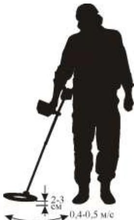
Избегайте касания датчиком грунта. Очень важно, чтобы расстояние между датчиком и поверхностью грунта оставалось постоянным. Имейте в виду, что качество выполнения этой операции непосредственно влияет на правильность идентификации искоемых объектов и количество ложных срабатываний звуковой индикации при высоких уровнях чувствительности.
