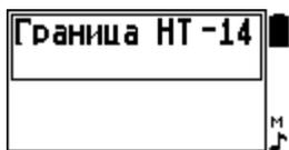
Данная опция позволяет сдвинуть границу озвучивания **цветного** нижнего тона (НТ) в сектор железа на нужную величину.
