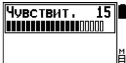
Данная опция позволяет проводить регулировку чувствительности Вашего прибора. Вы можете изменить её значение от 0 до 21. Помните, с увеличением чувствительности прибора не только возрастает глубина поиска, но и повышается возможность появления помех от линий электропередач и ложных срабатываний при ударах катушкой о препятствия. Выбирайте оптимальную чувствительность на месте поиска, исходя из формулы «наивысшее значение, возможное для стабильной работы прибора в данном месте».
