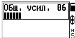
Опция позволяет регулировать усиление сигнала датчика одновременно для канала обнаружения (Пороговый тон) и канала идентификации (Чувствительность КТ). Такая настройка может быть использована на сильно замусоренных местах, пляжах и т.п., когда не требуется большая глубина поиска, а более важным является разделение близкорасположенных (в том числе и по глубине) предметов.
