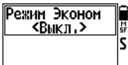
Особенностью этого режима является переход прибора на низкое потребление электроэнергии за счет снижения тока возбуждения ВТП. При этом наработка детектора может достигать до 40 часов (для АКБ 2800 мА/ч). Кроме того данный режим позволяет более достоверно осуществлять балансировку прибора по грунту при работе на высокоминерализованных морских пляжах. Режим можно рекомендовать при работе на замусоренных участках, где не требуется высокая чувствительность.
