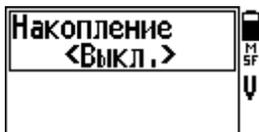
При выбранном режиме накопления «выкл» на экране будет виден лишь один годограф от последней идентифицированной прибором цели. При идентификации следующей цели предыдущий годограф стирается. В режиме «2», «3» на экране так же сохраняются годографы
