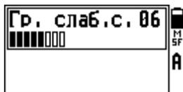
Регулировка данного параметра позволяет изменять громкость КТ слабых сигналов от мелких или глубоко лежащих целей. Малые значения этого параметра позволяют контролировать уровень сигнала по громкости звучания в более широком диапазоне изменения последних. Однако, сигналы от малых или предельно глубоких объектов могут быть слишком тихими. Поэтому, значение данного параметра подбирается экспериментально, под индивидуальные предпочтения пользователя.
