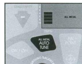
Используйте клавиши **Sensitivity** или **Threshold** для изменения чувствительности или для уменьшения посторонний шум. **Если прибор** находится в режиме максимальной чувствительности, то реакция прибора на предметы, зарытые в земле, сопровождается легким, еле слышимым посторонним шумом.
